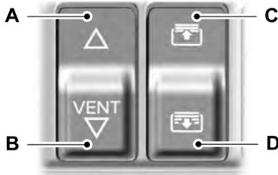
A **Techo solar abierto.** Presione y suelte para abrir el techo solar.
