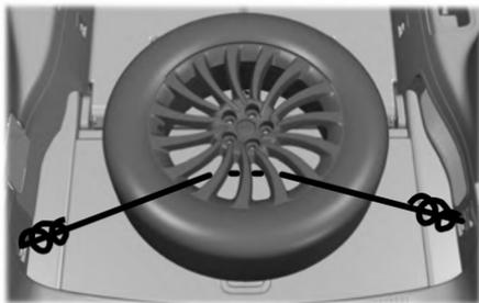
5. Ubique el punto de anclaje de carga delantero en la esquina trasera opuesta del área de carga. Enrosque la correa de sujeción a través del punto de anclaje y tire firmemente.
