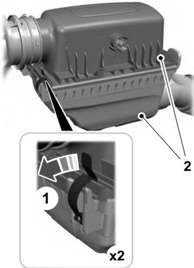
1. Retire los clips que aseguran la cubierta del alojamiento del filtro de aire.
