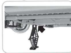
**Nota:** Utilice el riel del marco como punto de apoyo delantero para el gato, no el brazo de control. Hay una flecha marcada en el riel de marco.
