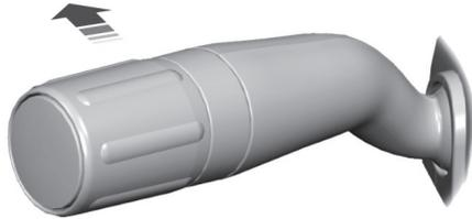
Empuje la palanca alejándola de usted para encender las luces altas.
