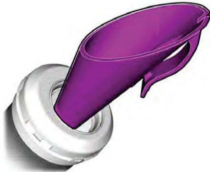
2. Inserte completamente el embudo de la tapa de recarga de combustible en la entrada de esta.
