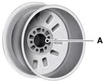
A Orificio del piloto de buje.
