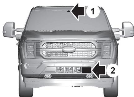
El sensor del radar tiene un campo de visión limitado. Es posible que no detecte vehículos o que detecte un vehículo más tarde de lo esperado en algunas situaciones. La imagen de vehículo adelante no se ilumina si el sistema no detecta un vehículo adelante de usted.
