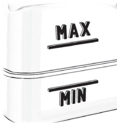
2. Revise el depósito de fluido para frenos para ver dónde está el nivel del fluido para frenos en relación con las marcas **MÍN.** y **MÁX.** en el depósito.
