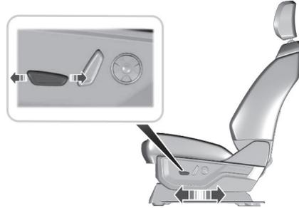
Si el asiento se detiene antes de alcanzar el final de la posición de recorrido o si aparece una obstrucción, se programa una nueva posición de detención.
