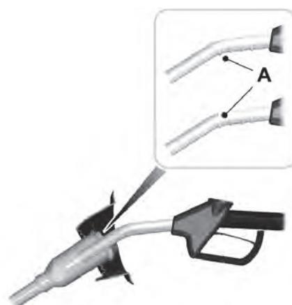
3. Inserte la boquilla del surtidor de combustible hasta la primera muesca. Mantenga la boquilla del surtidor de combustible apoyada sobre el tubo de llenado del tanque de combustible.
