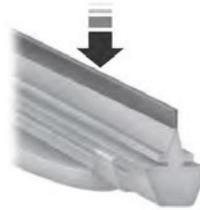
Pase la punta de los dedos por el borde de la plumilla para comprobar la aspereza.
