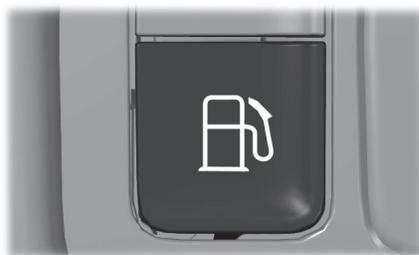
2. Presione el botón del lado izquierdo del cuadro de instrumentos junto al interruptor de faros delanteros para abrir la tapa de recarga de combustible. La tapa de recarga de combustible puede demorar hasta 15 segundos en abrirse antes de que pueda insertar la boquilla de llenado de combustible.
