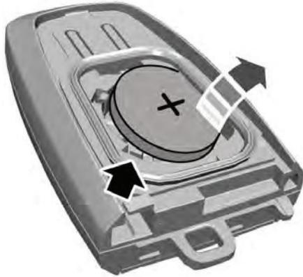
3. Inserte un destornillador y desmonte cuidadosamente la batería.
