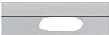
4. En la pared o en la pantalla, puede observar un patrón de luz con un borde horizontal perceptible hacia la derecha. Si el borde no está en la línea de referencia horizontal, ajuste la luz para que el borde esté a la misma altura que la línea de referencia horizontal.
