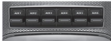
Los interruptores auxiliares solo operan cuando el encendido está en posición de activado o desactivado y el accesorio de retraso está activo, independientemente de si el motor está funcionando o no.
