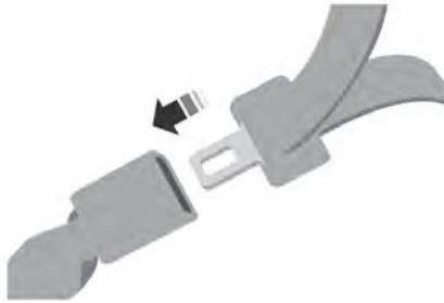
4. Inserte la lengüeta del cinturón en la hebilla correspondiente para dicha posición de asiento hasta que el pestillo se enganche. Jale de la lengüeta para asegurarse de que esté firmemente enganchada.
