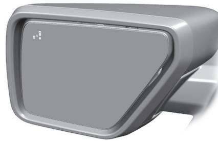
Cuando la advertencia de salida detecta un elemento del tráfico acercándose de un lado, se ilumina el indicador de alerta correspondiente en el espejo exterior. Si la alerta de advertencia de salida o la prevención opcional de advertencia de salida están activas, el mismo indicador de alerta parpadea. Véase **Indicadores del sistema de información del punto ciego** (página 346)..
