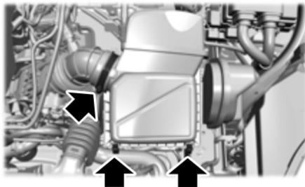
1. Con un destornillador, afloje la abrazadera de la cubierta del compartimento del filtro de aire.
