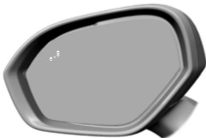
Cuando el sistema detecta un vehículo, un indicador de alerta se ilumina en el espejo exterior en el lado del vehículo que se aproxima. Si enciende la luz de giro de ese lado del vehículo, el indicador de alerta parpadea.
