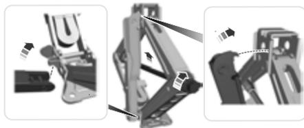
3. Vuelva a colocar el conjunto del kit del gato en la posición original del vehículo y asegúrelo con la tuerca tipo mariposa de plástico. Asegúrese de haber sujetado el gato de manera segura antes de conducir.
