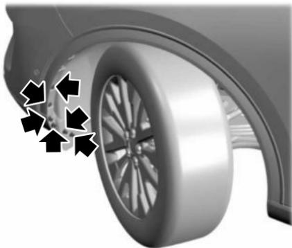
2. Retire las seis clavijas de seguridad inferiores del protector contra salpicaduras y tire de él hacia atrás.
