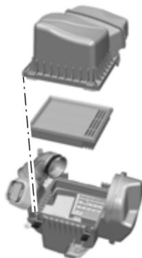
7. Coloque el filtro de aire nuevo. Tenga cuidado de no doblar los bordes del filtro contra el compartimento o la cubierta del compartimento del filtro de aire. Esto puede dañar el filtro y permitir que aire no filtrado entre al motor si no está asentado de manera adecuada.
