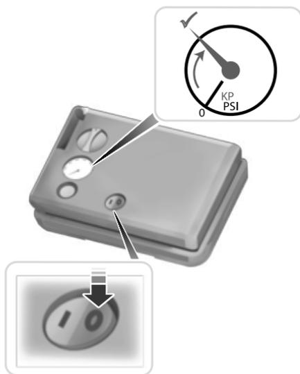
9. Cuando se alcanza la presión en los neumáticos recomendada, desactive el kit, desenchufe el cable y desconecte la manguera de la válvula del neumático. Vuelva a instalar la tapa de la válvula del neumático y coloque el kit nuevamente en el área de almacenamiento.
