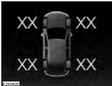
El sistema de control de presión de los neumáticos mide la presión de los neumáticos y envía las lecturas de la presión de los neumáticos al vehículo. Puede visualizar las lecturas de presión de los neumáticos a través de la pantalla de información. Véase **Información general** (página 86). La luz de advertencia de baja presión de los neumáticos se enciende cuando la presión de estos está considerablemente baja. Si la luz de advertencia se enciende, los neumáticos
