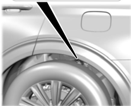
**Nota:** la palanca de accionamiento manual está en el área del compartimiento de la rueda trasera del lado del conductor.
