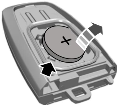
3. Inserte una herramienta adecuada, por ejemplo, un destornillador, en la posición que se muestra y retire la pila con cuidado.
