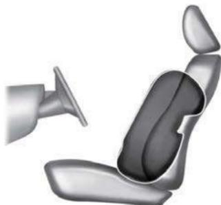
Los airbags laterales se diseñaron para inflarse entre el panel de la puerta y el ocupante para mejorar la protección en determinadas colisiones.
