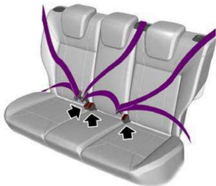
Si tira bruscamente o si el vehículo se encuentra en una pendiente, el cinturón de seguridad puede quedar trabado. Tire el cinturón de seguridad de manera continua para desenrollarlo.
