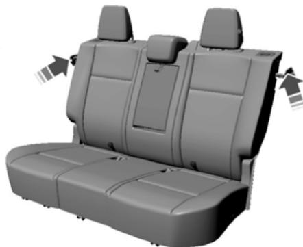
Asegure el respaldo en una posición completamente vertical y enganchada, los pestillos se asegurarán en los delanteros montados en el pilar del costado.
