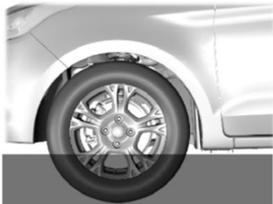
Cuando conduzca a través de agua, conduzca lentamente y no detenga el vehículo. El rendimiento del freno y la tracción pueden ser limitados. Luego de conducir a través del agua y tan pronto como sea seguro, realice lo siguiente:
