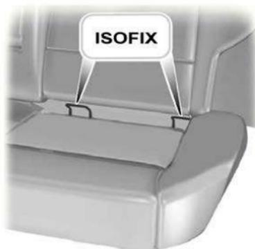
2. Empuje firmemente el asiento del niño para atrás para fijar los puntos de anclaje inferiores de ISOFIX.
