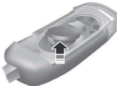
**Nota:** No toque los contactos de la pila ni la tarjeta de circuito impreso con el destornillador.
