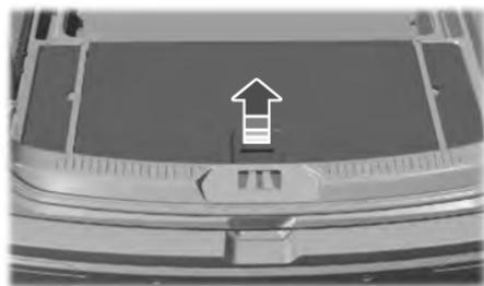
Los vehículos con llanta de refacción tamaño estándar puede ajustar el piso de carga en dos posiciones. Puede colocar el frente del piso de carga encima, para una posición alta, o debajo, para una posición baja, de los bordes detrás de los asientos traseros. La parte trasera del piso de carga siempre se asienta en los dos pequeños anaqueles de la moldura de la compuerta levadiza.
