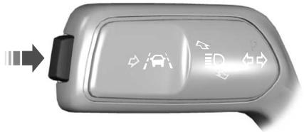
Presione el botón ubicado en la palanca de las luces de giro para activar o desactivar el sistema.
