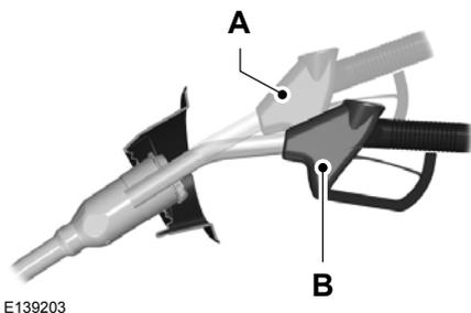
**Nota:** Si sostiene la boquilla de la bomba de combustible en la posición A durante la recarga de combustible podría verse afectado el flujo de combustible, y la boquilla de la bomba de combustible podría detenerse antes de que el tanque de combustible esté lleno.
