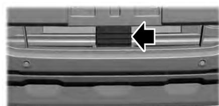
Aparece un mensaje si hay un objeto que obstruye las señales de radar del sensor. El sensor se encuentra detrás de la parrilla inferior. El sistema no puede detectar un vehículo adelante y no funciona cuando hay algo que obstruye la señal del radar.
