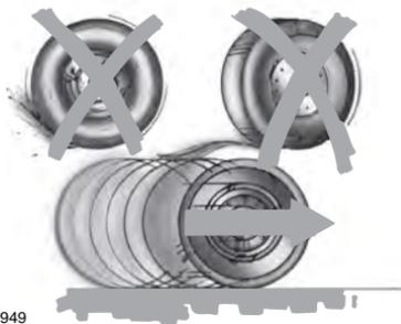
Descienda por la pendiente con la misma marcha que utilizaría para subirla para evitar frenar demasiado y que se sobrecalienten los frenos. No descienda en punto muerto. Desacople la supermarcha o desplace la palanca selectora a una marcha más baja. Cuando descienda por una pendiente pronunciada, evite frenar con rapidez y brusquedad, pues perderá el control. Para poder realizar maniobras, las ruedas delanteras deben estar girando.
