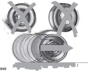
Descienda cuestas en la misma velocidad que utilizaría para subirlas, a fin de evitar el uso excesivo de los frenos y su consiguiente sobrecalentamiento. No descienda en neutral; en cambio, desactive la sobremarcha o cambie manualmente a una velocidad inferior. Al descender cuestas empinadas, evite frenadas bruscas ya que podría perder el control del vehículo. Si las ruedas delanteras se deslizan o giran en vacío no es posible guiar el vehículo.
